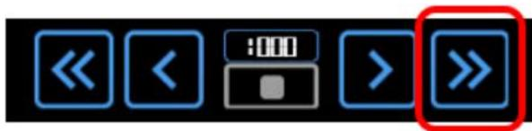
第二步，设置微调步数为 10 步，点击一下向内移动的微调按钮，观察另一侧的调焦手轮是否转动。
