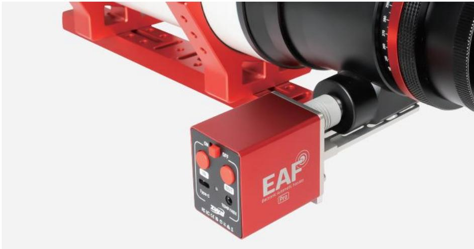
拿到设备后，请将电调焦 Type-C 接口连接到电脑或 ASIAIR 的 USB 端口、充电宝或充电器进行激活，然后将开关拨至“ON”位置，如果可以正常开机(此时指示灯会亮起)则成功激活成功。
