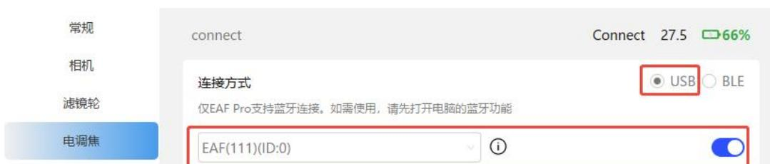
蓝牙通讯：EAF Pro (EAF 不支持) 还支持蓝牙无线通信。首先要打开 PC 蓝牙功能，在“ASISudio”页面选择“BLE”通讯方式，扫描蓝牙设备 ID 并启动连接开关。
