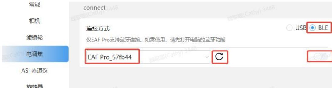
按照页面上弹出的信息，在 60s 内单击 EAF Pro 机身上的 IN 或 OUT 按钮进行蓝牙配对 (配对成功后设备发出的蜂鸣声会随之消失)，如果之前进行过蓝牙连接就不需要重复配对。
