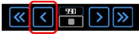
第三步，一次次点击向内移动的微调按钮，观察另一侧的调焦手轮，手轮开始转动说明已经走完回差。那么转动之前所点击的次数 $\times 10$  就是回差的步数。
