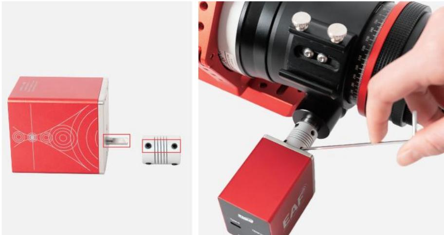
用提供的 M4 螺钉将电调焦主体固定到连接板上，并将连接板固定到调焦座组件中的相应安装孔上，注意连接板与电调焦安装面贴合无间隙且与调焦座表面相对平行；
