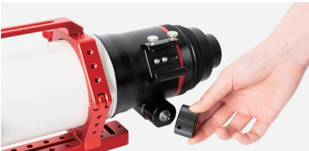
将联轴器安装在望远镜调焦座轴上并用 2mm 六角扳手拧紧锁紧螺钉；
